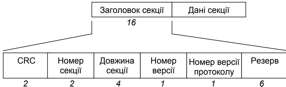
Рис. 2. Огляд структури секції. Числа, виділені курсивом, показують довжину в байтах відповідних полів
